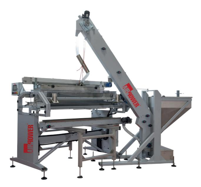
Powder Grits è la macchina per l'applicazione di graniglie e polveri. Il sistema è composto da un serbatoio/elevatore per il caricamento del prodotto, da una testa per la distribuzione sulla piastrella e da un nastro per il recupero del prodotto in eccesso. Tramite un pannello di controllo è possibile scegliere tra differenti tipologie di lavoro e memorizzare le diverse ricette create.
