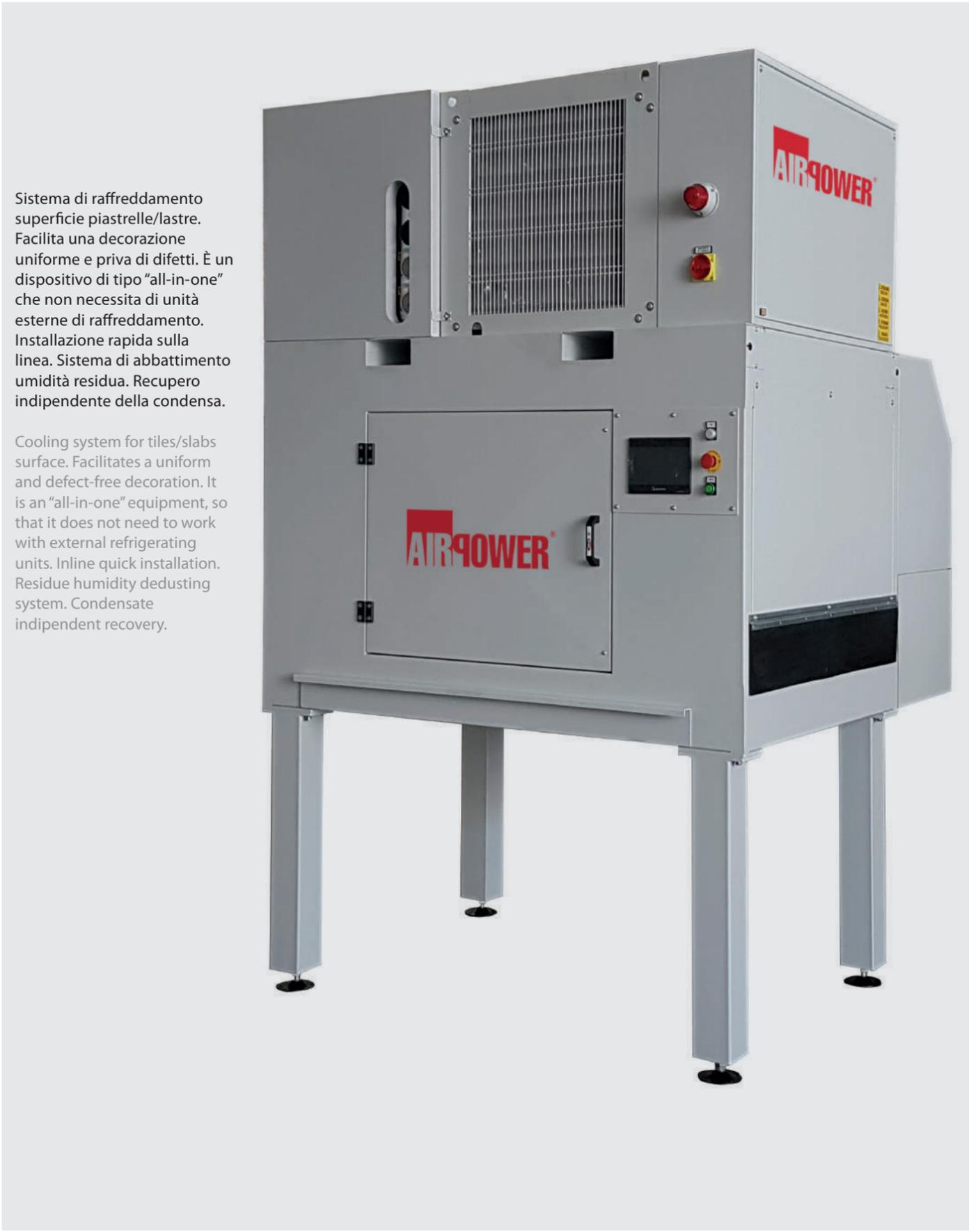
Sistema di raffreddamento superficie piastrelle/lastre. Facilita una decorazione uniforme e priva di difetti. È un dispositivo di tipo "all-in-one" che non necessita di unità esterne di raffreddamento. Installazione rapida sulla linea. Sistema di abbattimento umidità residua. Recupero indipendente della condensa.
